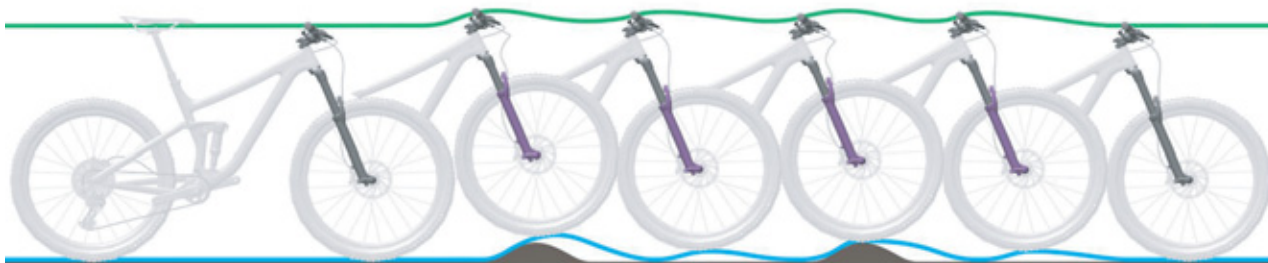
Paveikslėlis 70: Per greitas amortizuojančių šakių atšokimas
