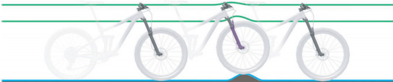
Paveikslėlis 61: Optimalios važiavimo charakteristikos nelygiame kelyje
