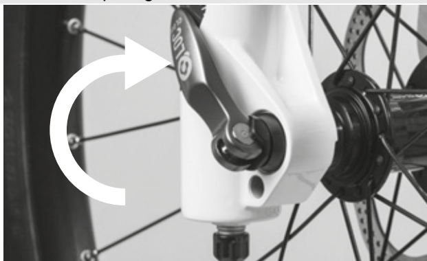
Paveikslėlis 32: Ekscentriko uždarymas
