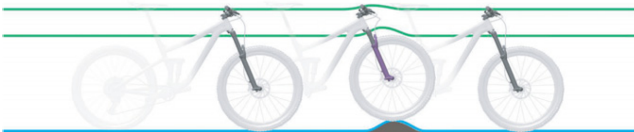
Paveikslėlis 7: Optimali šakių važiavimo charakteristika nelygumuose
