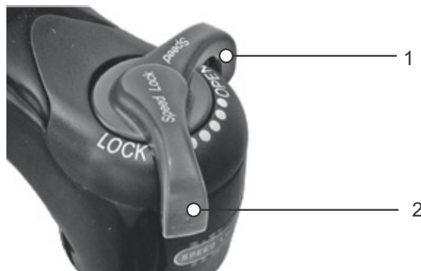
Paveikslėlis 62: „Suntour“ kompresiniai slopintuvai atviroje (1) ir uždaroje (2) padėtyje
