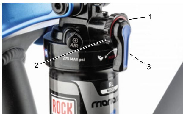
Figura 77: Regolazione della rigidità dell'ammortizzatore a stadi di trazione con la manopola di regolazione (1) dell'ammortizzatore del carro posteriore
