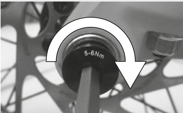
Figura 26: Serraggio della vite di sicurezza
