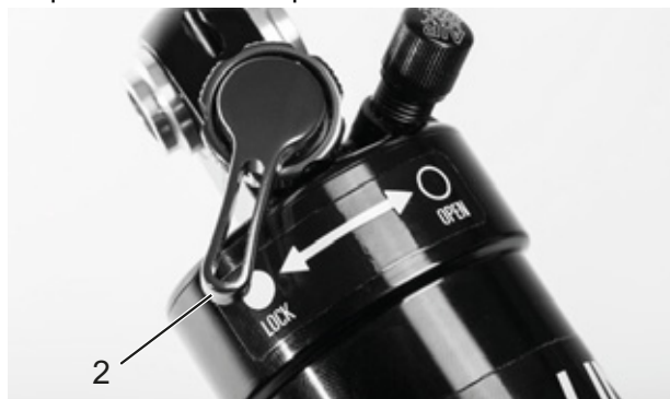
Figura 76: Regolatore della compressione Suntour chiuso (2)
