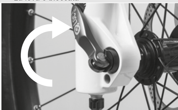
Figura 38: Chiusura del bloccaggio rapido
