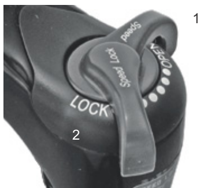
Figura 74: Regolatore della compressione Suntour con posizioni OPEN (1) e LOCK (2)
