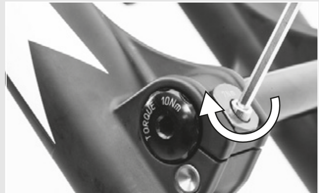
Figura 28: Serraggio del perno
