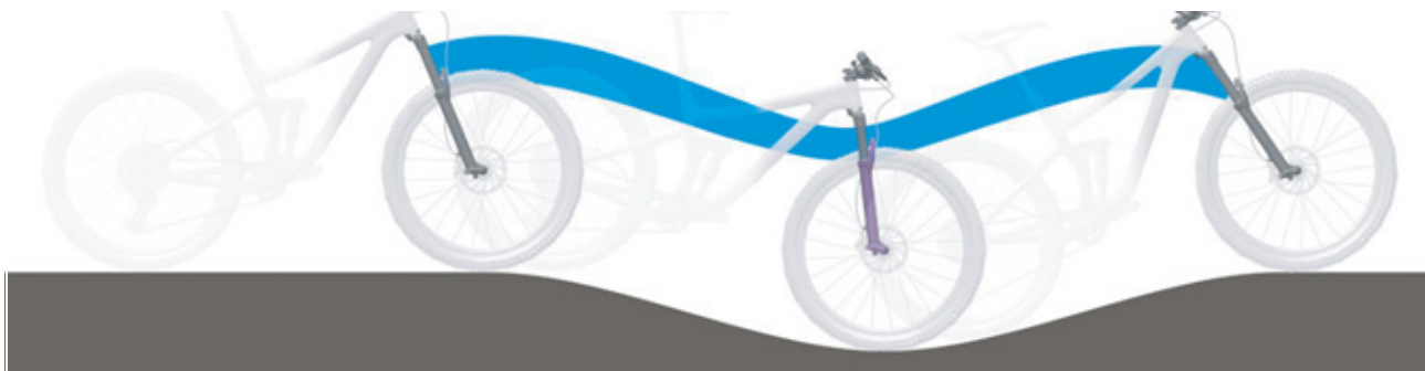
9. ábra: A villa optimális menetviselkedése dombos terepen
