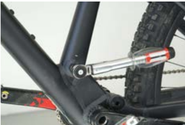
84. ábra: A nyeregcsőtengely meghúzása
