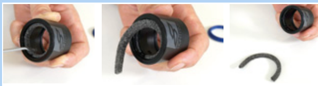
203. ábra: A filcgyűrű eltávolítása
