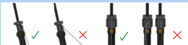
184. ábra: Helyesen és hibásan beállított bovdent
