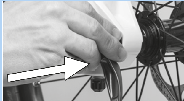
76. ábra: A gyorszár betolása nyilirányban
