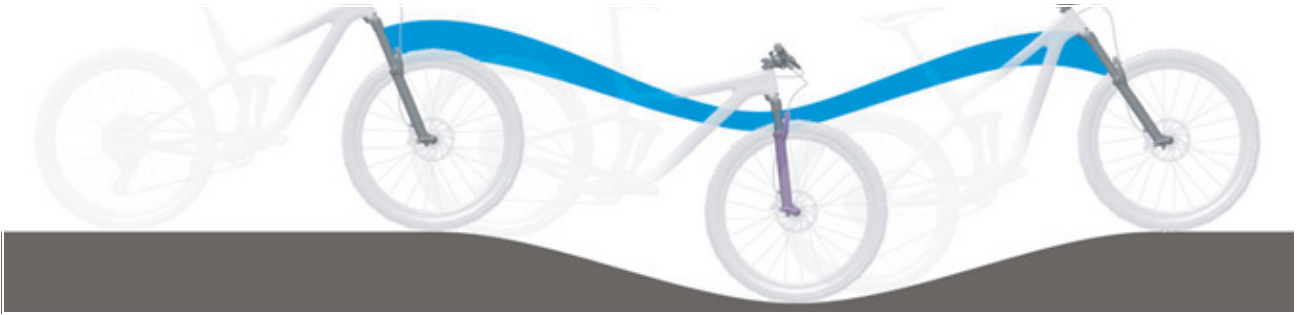
223. ábra: A teleszkópos villa túl puha rugózása hegymenetben
