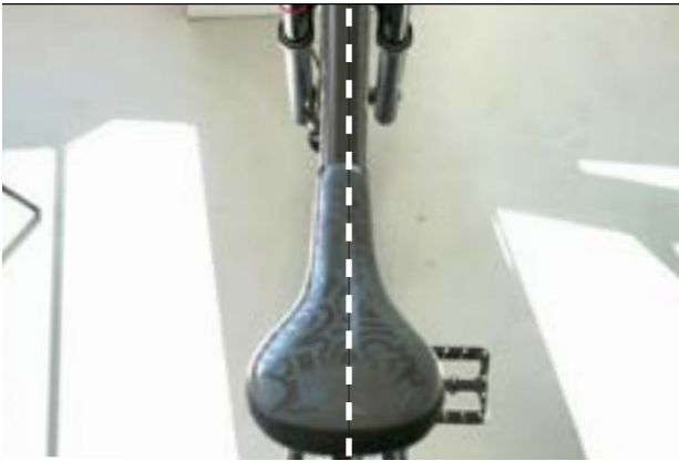
83. ábra: Nyereg beállítása menetirányban
