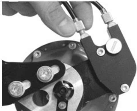
150. ábra: Külső váltóvezérléssel rendelkező Rohloff agyváltozatok húzásbeállítója a kötéldobozon van, ami a bal oldalon található
