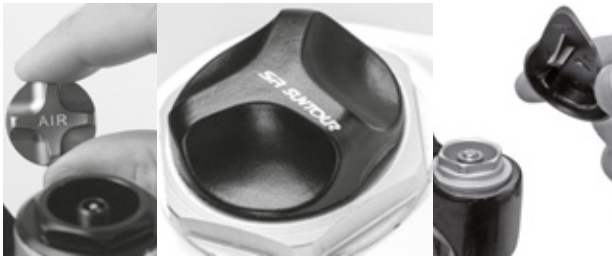
113. ábra: Csavarburkolatok különböző kivitelekben
