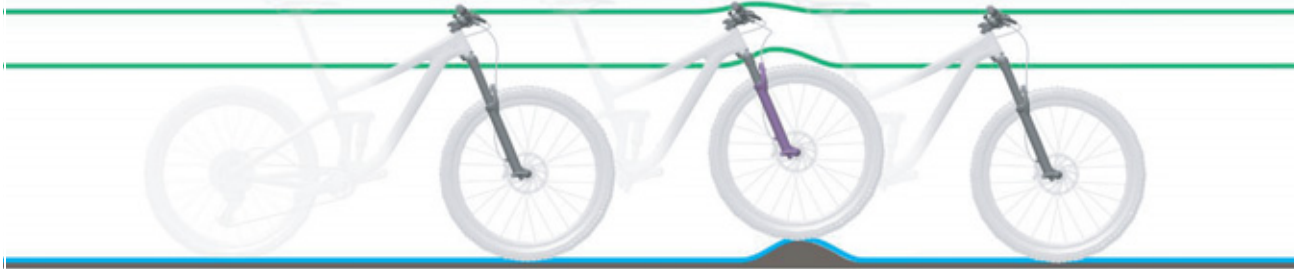
134. ábra: Optimális menetviselkedés egyenetlenségek esetén
