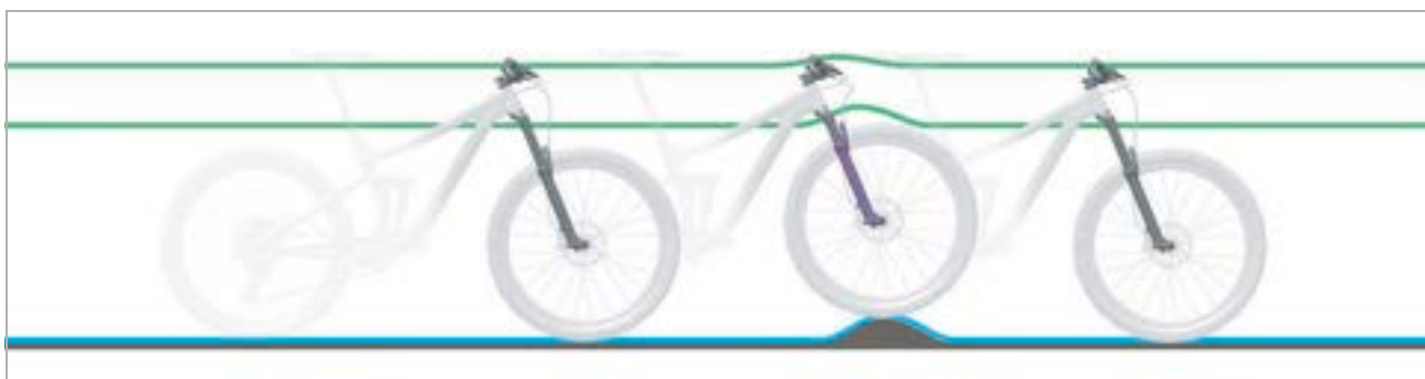
Obr. 204: Tvrdě a měkce nastavený tlumič komprese
