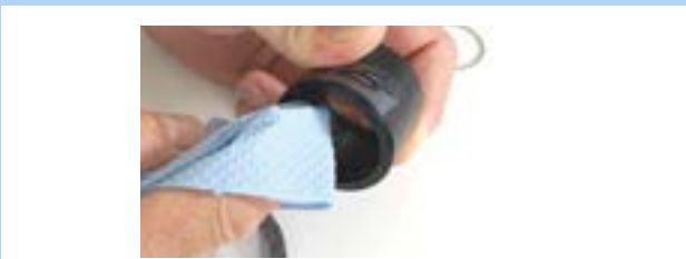
Obr. 293: Čištění vnějšího pouzdra
