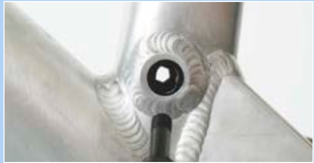
Obr. 306: Otvor v rozhraní Postpin
