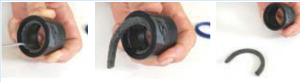
Obr. 292: Odstranění plstěného kroužku
