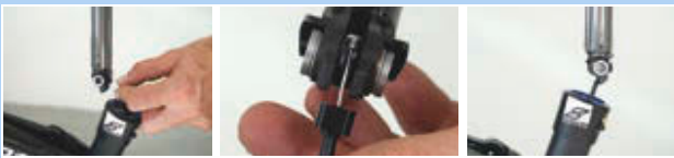
Obr. 304: Zavedení a zasunutí sedlovky
