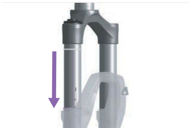
Obr. 168: Posunutí O-kroužku odpružené vidlice
