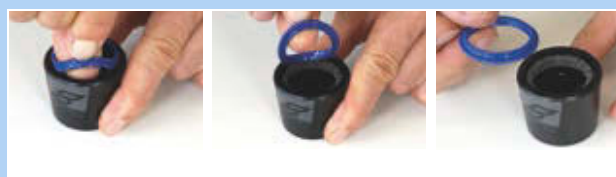
Obr. 256: Vytažení stíracího kroužku
