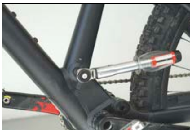
Obr. 118: Utažení osy sedlovky
