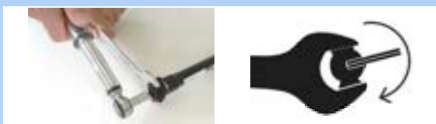
Obr. 268: Nastavení ve směru pohybu hodinových ruček
