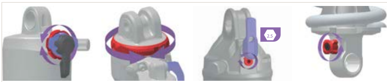
Obr. 176: Poloha a tvar nastavovacího šroubu odskoku (tlumič zadního odpružení) jsou závislé na modelu. Nastavovací šrouby odskoku jsou vždy červené
