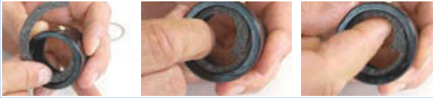
Obr. 259: Vložení plstěného kroužku
