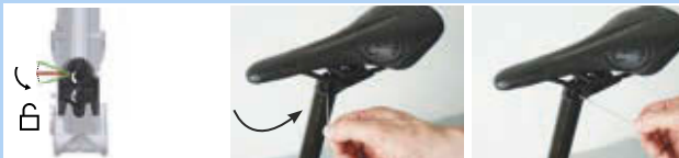
Obr. 246: Přešunění ovladače nastavení výšky do polohy „Otevřeno“
