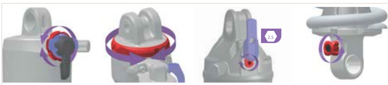
Obr. 324: Poloha a tvar nastavovacího šroubu odskoku (tlumič zadního odpružení) (červený) jsou závislé na modelu
