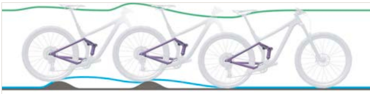
Obr. 325: Příliš pomalé roztahování tlumiče zadního odpružení
