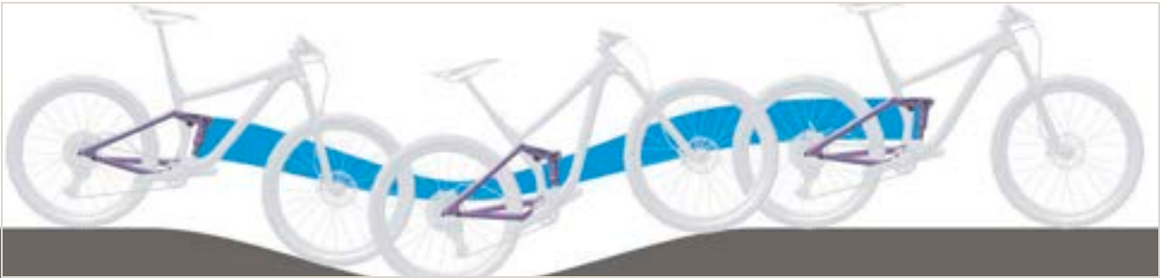
Obr. 335: Příliš měkké odpružení tlumiče zadního odpružení v horách
