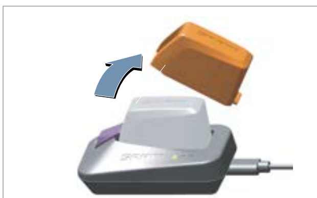
Obr. 350: Odstranění krytu akumulátoru
