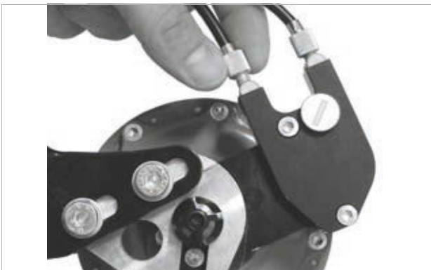
Obr. 240: Náboje ROHLOFF s externím ovládním řazení mají seřizovače napnutí na lanovodu, který je umístěn na levé straně
