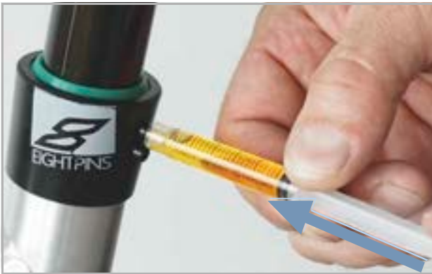
Obr. 211: Namazání sedlovky EIGHTPINS
