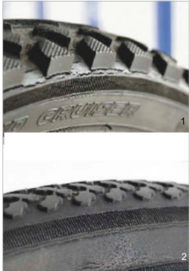
Obr. 214: Příklady únavových trhlin (1) a trhlin vzniklých stárnutím (2)
