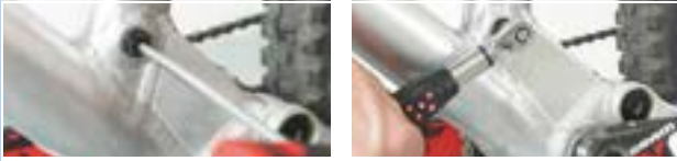
Obr. 276: Upevnění osy Postpin
