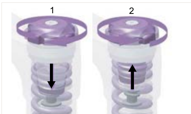
Obr. 167: Otáčení nastavovacího kolečka SAG dovnitř (1) a ven (2)
