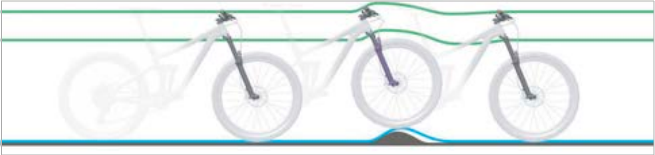
Obr. 322: Příliš tvrdé tlumení odpružené vidlice u nerovnosti
