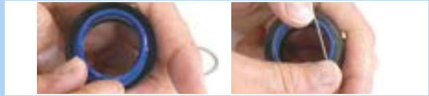
Obr. 295: Vložení a upevnění stíracího kroužku
