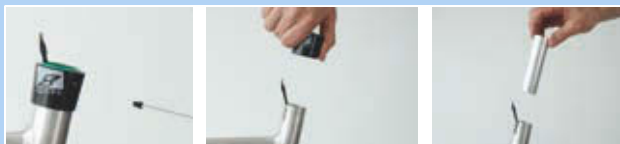
Obr. 254: Demontáž vnějšího pouzdra a kluzného pouzdra
