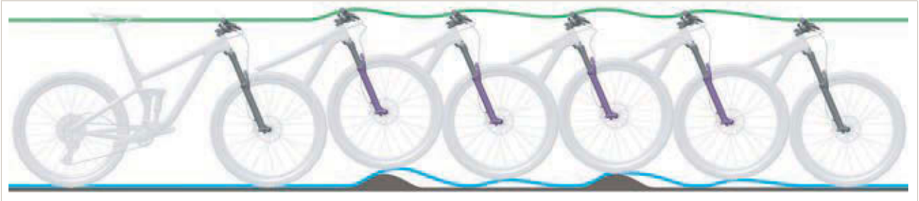
Obr. 309: Příliš rychlé roztahování odpružené vidlice
