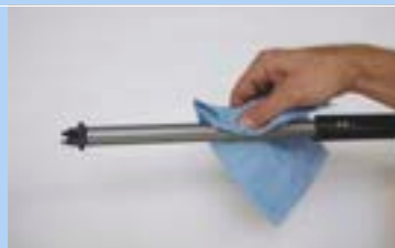
Obr. 299: Očištění podélné vodicí drážky
