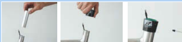
Obr. 270: Montáž kluzného pouzdra a vnějšího pouzdra
