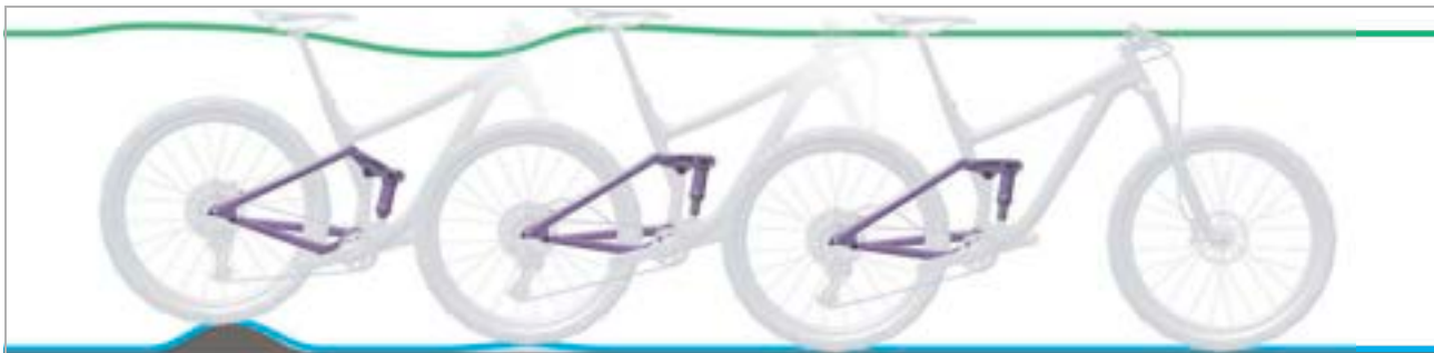
Obr. 331: Příliš rychlé roztahování tlumiče zadního odpružení
