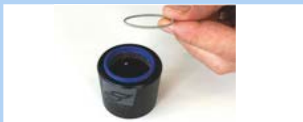
Obr. 290: Vyjmutí pružné podložky
