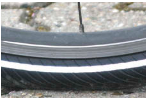
Obr. 143: Správný tlak. Plášť se působením hmotnosti těla téměř nezdeformuje
