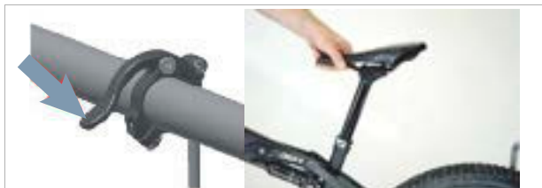
Obr. 122: Vysunutí hydraulické plynové tlačné pružiny
