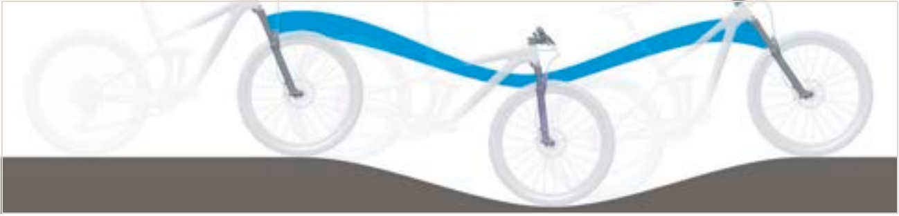
Obr. 313: Příliš měkké odpružení odpružené vidlice v horách
