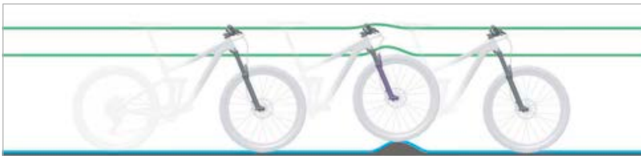
Obr. 23: Optimální chování odpružené vidlice při jízdě u nerovnosti
