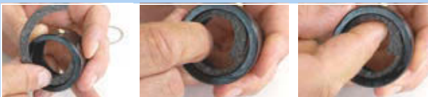
Obr. 294: Vložení plstěného kroužku
