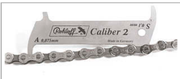
Obr. 220: Příklad kalibru ROHLOFF
