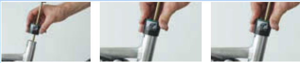
Obr. 278: Nasazení vnějšího pouzdra
