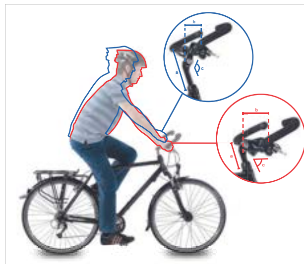
Obr. 141: Poloha u městského (modrá) a trekingového kola (červená) při změně úhlu
