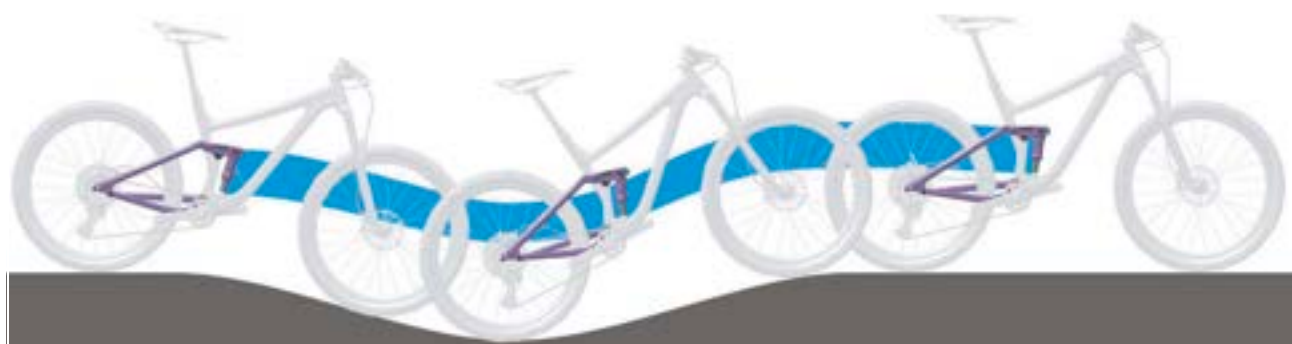
Obr. 9: Optimální chování tlumiče zadního odpružení při jízdě v kopcovitém terénu
