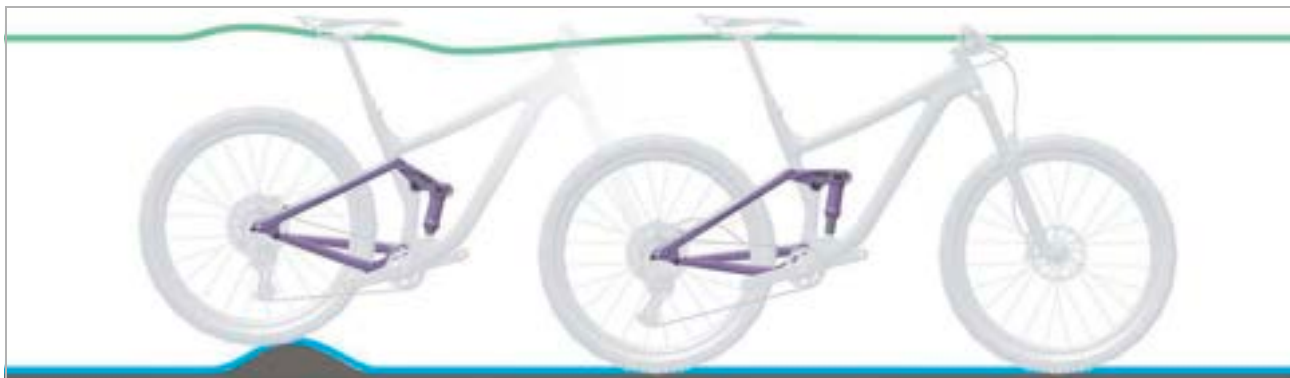
Obr. 187: Optimální chování tlumiče zadního odpružení při jízdě u nerovností
