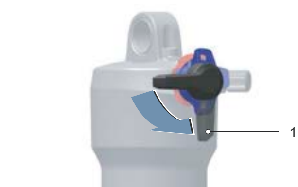
Obr. 184: Otevřená poloha (1) nastavovacího šroubu komprese (černá)
