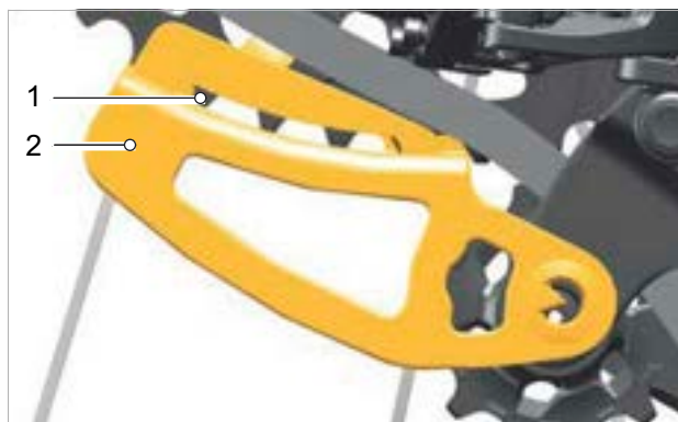
Obr. 154: Výřez okna (1) se zuby v kalibru Chain Gap (2)
