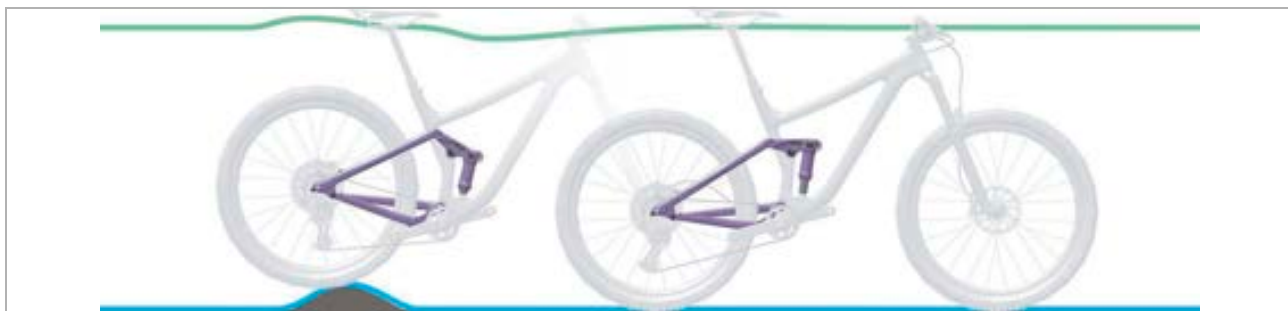
Obr. 7: Optimální chování tlumiče zadního odpružení při jízdě u nerovností
