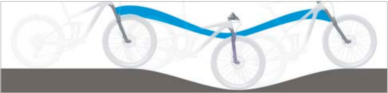
Obr. 321: Příliš měkké odpružení odpružené vidlice v horách
