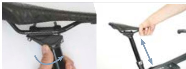
Obr. 123: Nastavení výšky sedlovky
