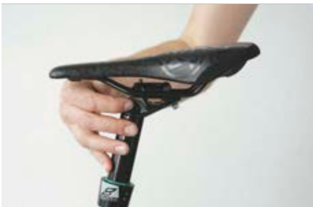
Obr. 131: Nastavení sklonu sedla na nastavovacím kolečku
