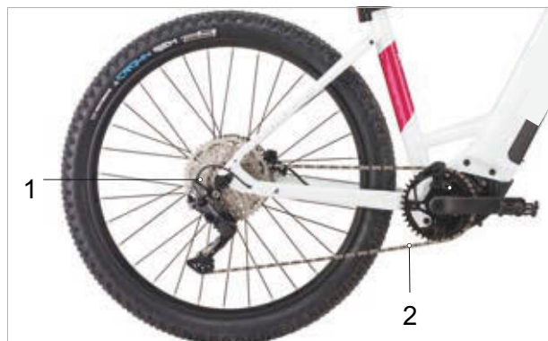
Obr. 50: Schéma řetězového převodu s přesmykačem
