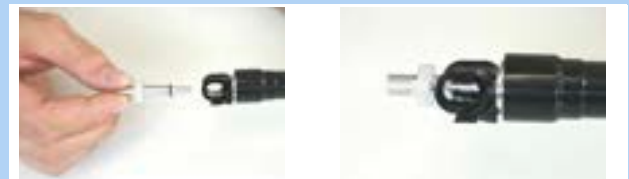
Obr. 263: Zašroubování adaptéru ventilu
