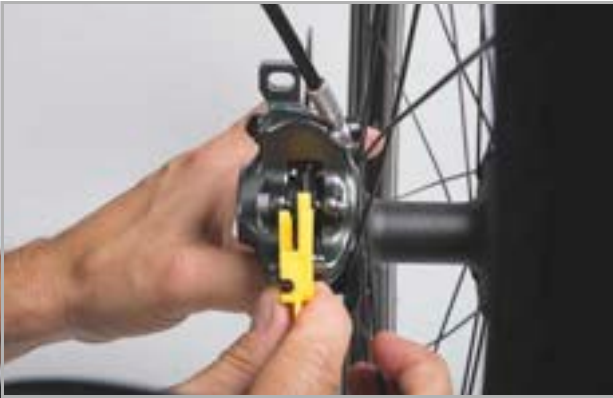
Obr. 215: Kontrola brzdového obložení v namontovaném stavu pomocí přepravní pojistky
