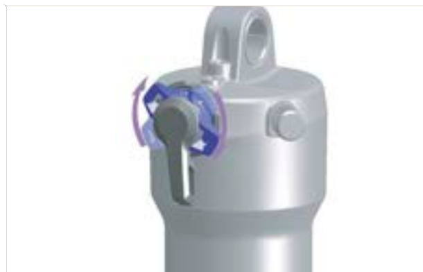
Obr. 186: Tvrdší nastavení nastavovacím šroubem komprese
