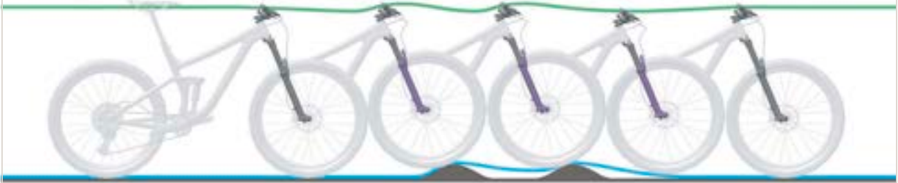
Obr. 311: Příliš pomalé roztahování odpružené vidlice
