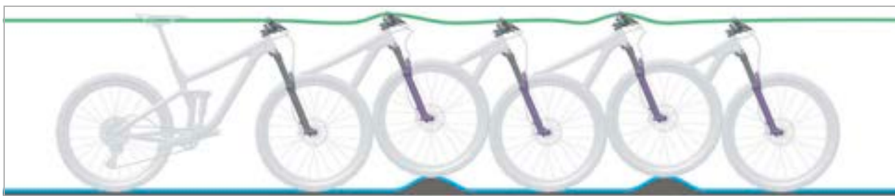
Obr. 21: Optimální chování odpružené vidlice při jízdě
