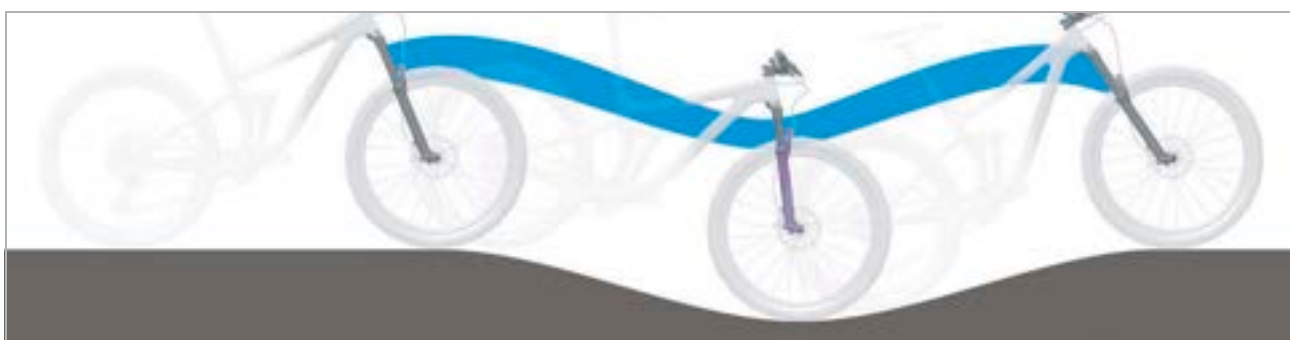
Obr. 22: Optimální chování odpružené vidlice při jízdě v kopcovitém terénu
