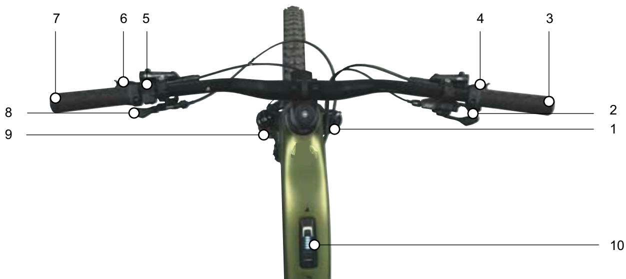
Obr. 60: Detailní pohled na řídítka s palubním počítačem System Controller BOSCH a ovládací jednotkou Mini Remote, příklad
