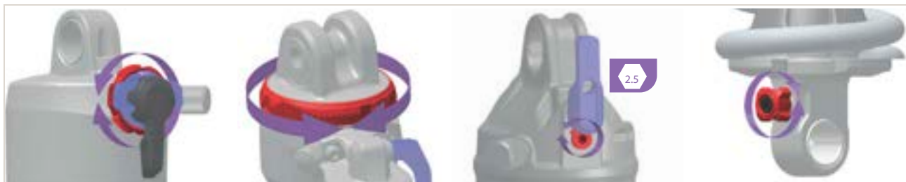
Obr. 326: Poloha a tvar nastavovacího šroubu odskoku (červený) jsou závislé na modelu
