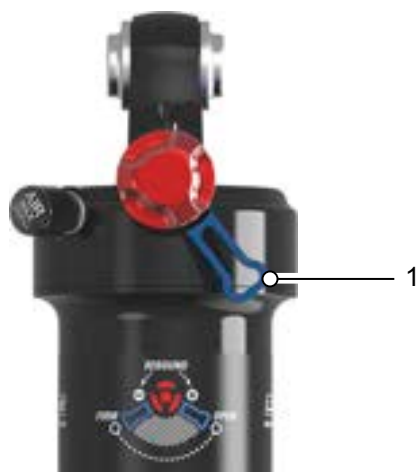
Tabulka 56: Nízkorychlostní páčka (tlumič zadního odpružení) (1) na tlumiči zadního odpružení EDGE LOR8
