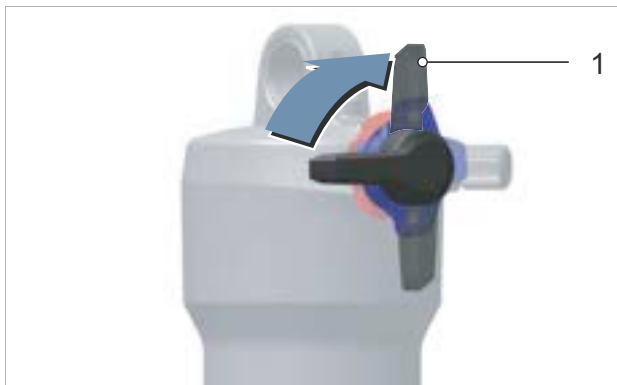
Obr. 183: Zavřená poloha (1) nastavovacího šroubu komprese (černá)
