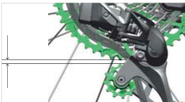
Obr. 159: Vzdálenost 3 mm mezi vodící kladkou a zuby
