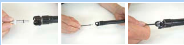
Obr. 265: Upevnění krytu ventilku kazety
