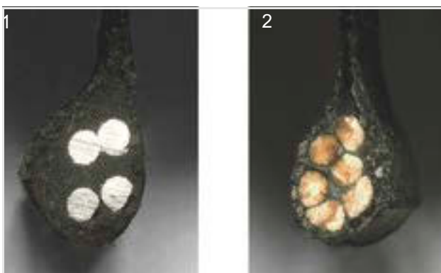
Obr. 31: Ocelová patka (1) a kevlarová patka (2)
