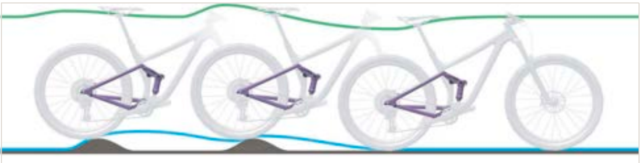
Obr. 333: Příliš pomalé roztahování tlumiče zadního odpružení
