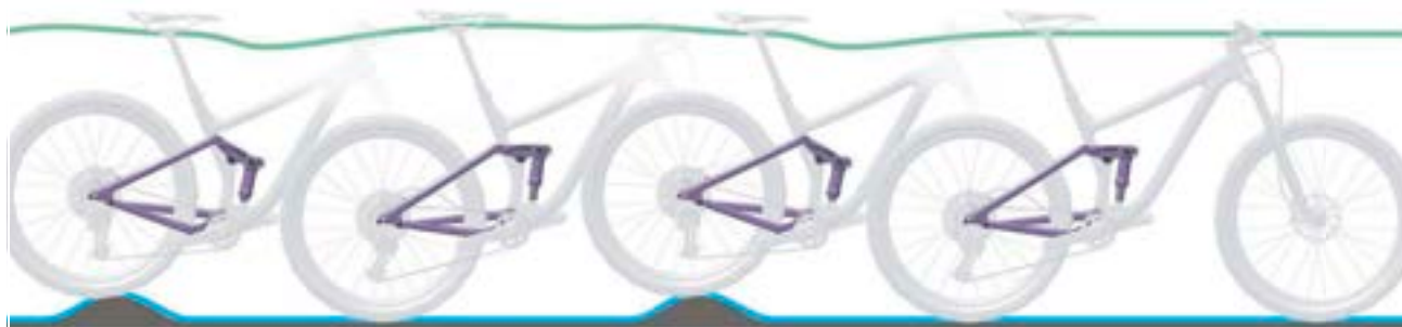
Obr. 8: Optimální chování tlumiče zadního odpružení při jízdě
