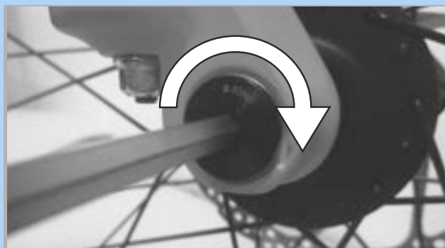
Obr. 90: Utažení osy ve směru šipky
