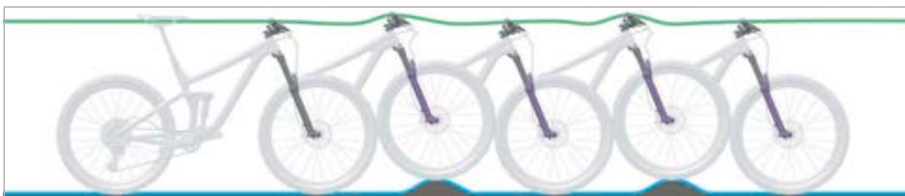
Obr. 24: Optimální chování odpružené vidlice při jízdě
