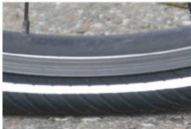
Obr. 144: Příliš nízký tlak
