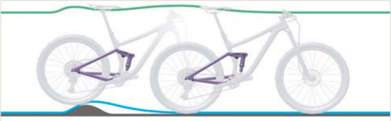
Obr. 329: Příliš tvrdé tlumení tlumiče zadního odpružení u nerovnosti
