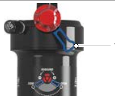
Tabulka 55: Páčka komprese (tlumič zadního odpružení) (1) na tlumiči zadního odpružení EDGE plus 2CR
