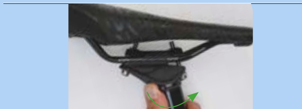
Obr. 297: Otevření nastavení výšky
