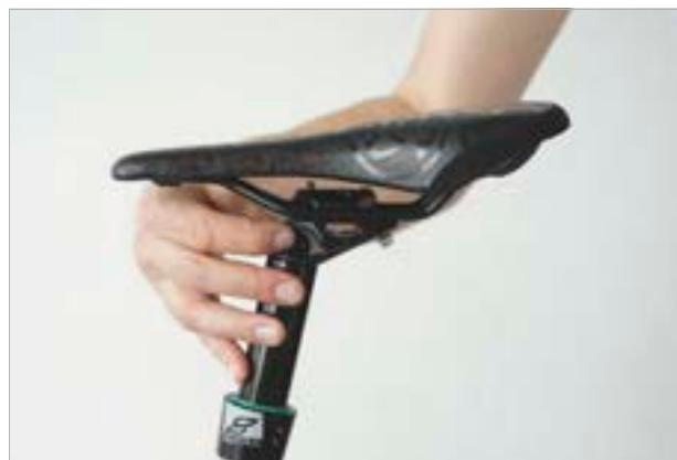
Obr. 133: Nastavení sklonu sedla nastavovacím kolečkem
