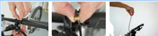
Obr. 206: Uvolnění dálkového ovládání
