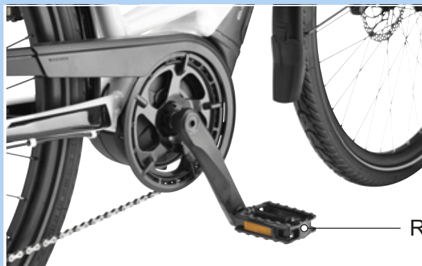
Obr. 69: Pedál R pravého ramena kliky
