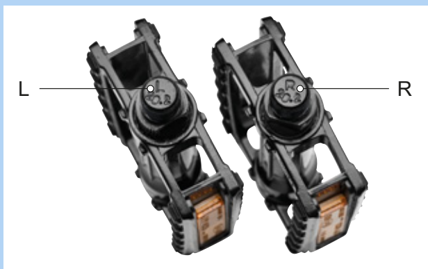
Obr. 67: Příklad označení pedálů
