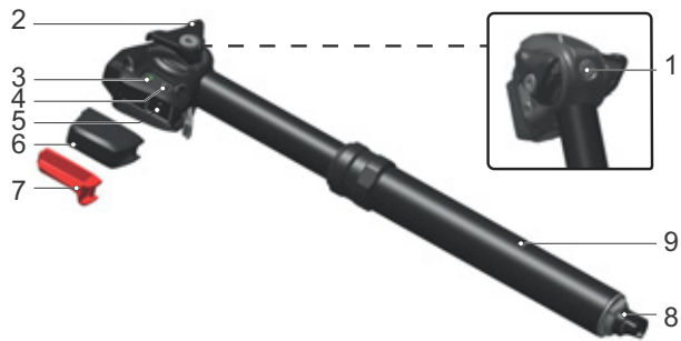
Obr. 32: Konstrukce ROCKSHOX Reverb odpružené sedlovky AXS
