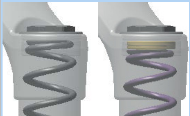
Obr. 111: Otáčení nastavovacím kroužkem předpětí dovnitř a ven
