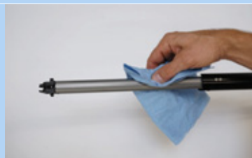
Obr. 220: Očištění podélné vodicí drážky
