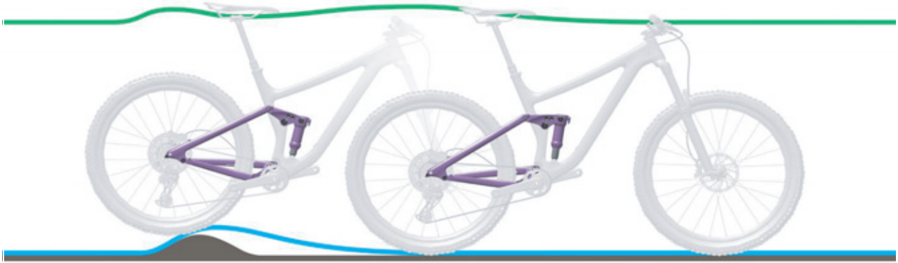
Obr. 251: Příliš tvrdé tlumení tlumiče zadního odpružení u nerovnosti
