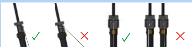
Obr. 194: Správné a nesprávné vedení bovdenů
