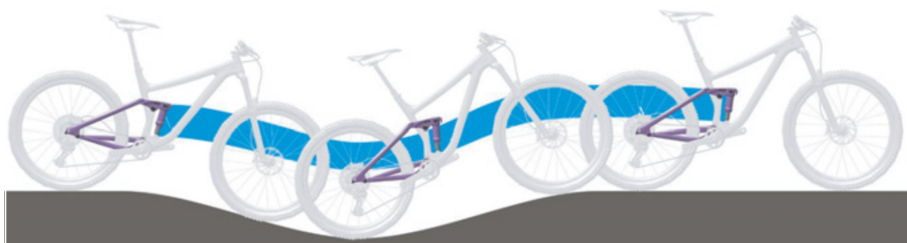
Obr. 21: Optimální chování tlumiče zadního odpružení při jízdě v kopcovitém terénu
