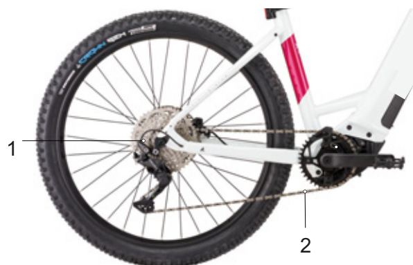
Obr. 35: Schéma řetězového pohonu s přesmykačem
