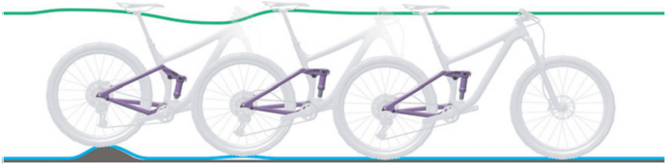
Obr. 245: Příliš rychlé roztahování tlumiče zadního odpružení
