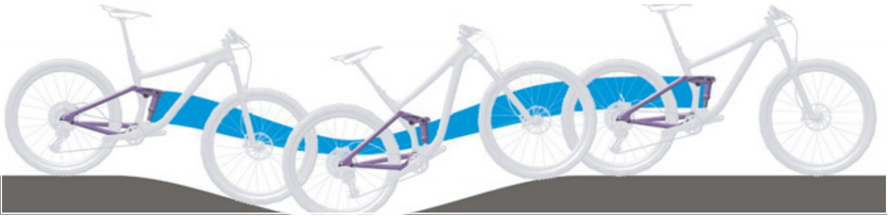
Obr. 249: Příliš měkké odpružení tlumiče zadního odpružení v horách
