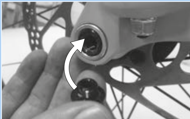
Obr. 55: Zasunutí páky rychloupínáku do osy
