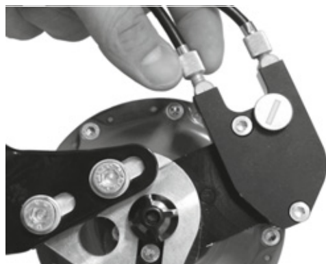
Obr. 160: Náboje Rohloff s externím ovládním řazení mají seřizovače napnutí na lanovodu, který je umístěn na levé straně
