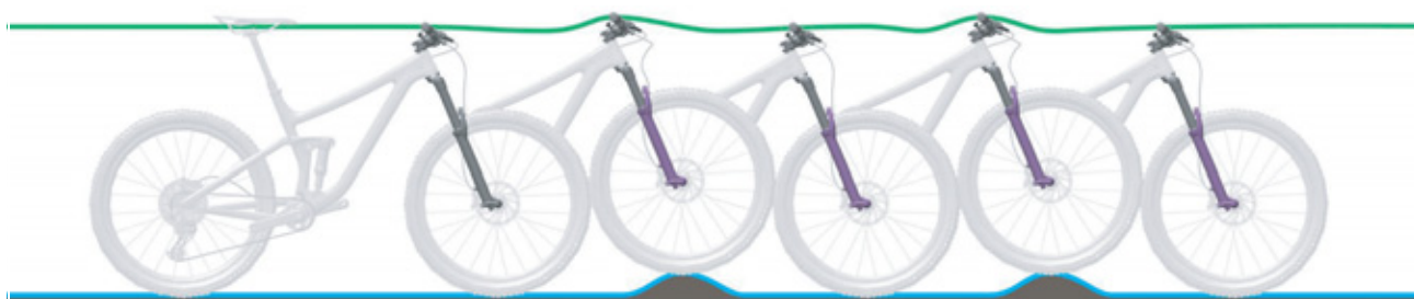
Obr. 114: Optimální chování vidlice při jízdě
