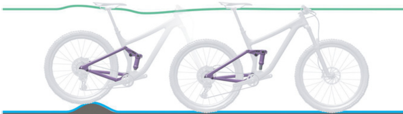
Obr. 119: Optimální chování tlumiče zadního odpružení při jízdě u nerovností
