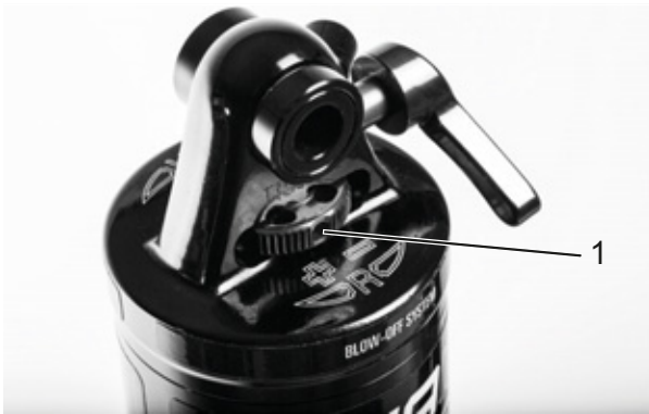
Obr. 248: Nastavovací šroub odskoku Suntour (1) na tlumiči zadního odpružení
