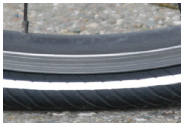
Obr. 89: Příliš nízký tlak
