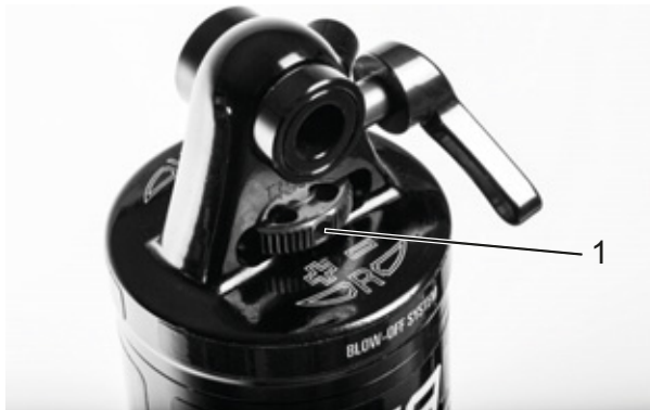
Obr. 246: Nastavovací šroub odskoku Suntour (1) na tlumiči zadního odpružení
