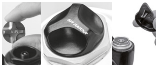
Obr. 46: Šroubovací krytka může mít různé provedení
