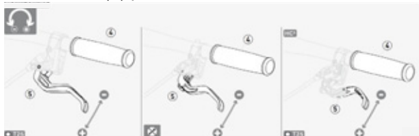
Obr. 43: Nastavení vzdálenosti brzdové páky kotoučové brzdy Magura
