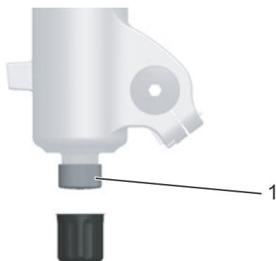
Obr. 52: Nastavovací šroub odskoku FOX (1) na patce nohy vidlice
