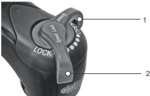
Obr. 79: Tlumič komprese Suntour v otevřené (1) a zavřené (2) poloze
