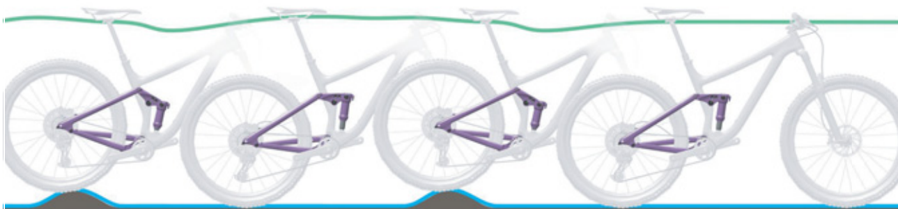
Obr. 49: Optimální chování tlumiče zadního odpružení při jízdě
