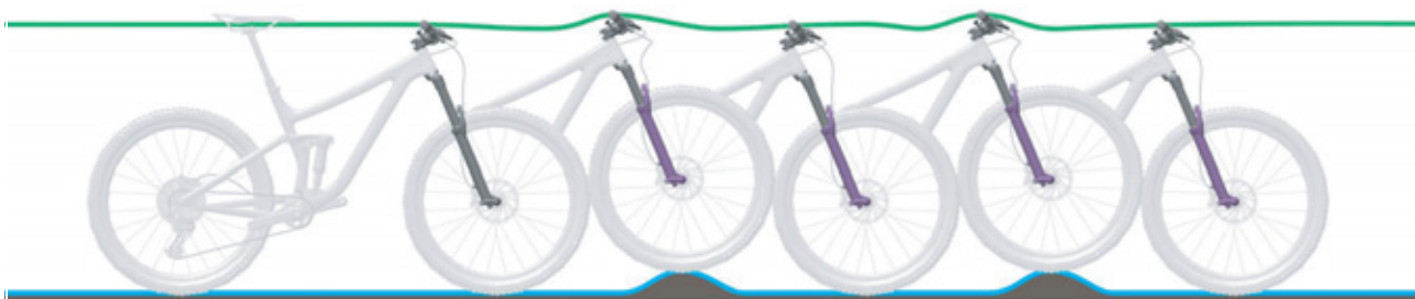
Obr. 48: Optimální chování vidlice při jízdě
