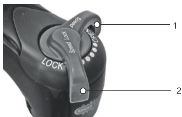
Obr. 64: Tlumič komprese Suntour v otevřené (1) a zavřené (2) poloze
