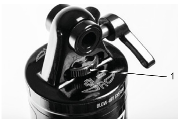
Obr. 81: Otočení tlumiče zpětného odskoku ve směru hodinových ručiček
