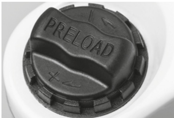
Obr. 45: Nastavovací kolečko SAG na korunce odpružené vidlice
