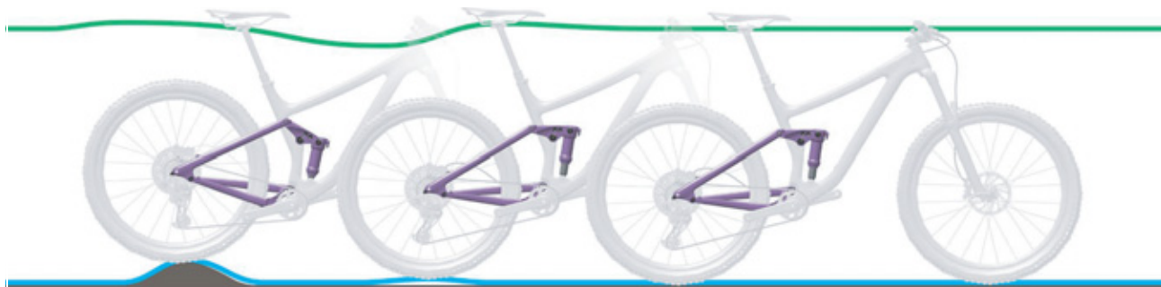
Obr. 80: Příliš rychlé roztahování tlumiče zadního odpružení
