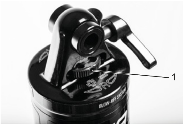
Obr. 83: Otočení tlumiče zpětného odskoku proti směru hodinových ručiček
