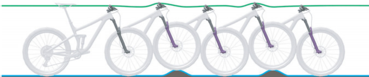
98. ábra: A villa optimális menetviselkedése
