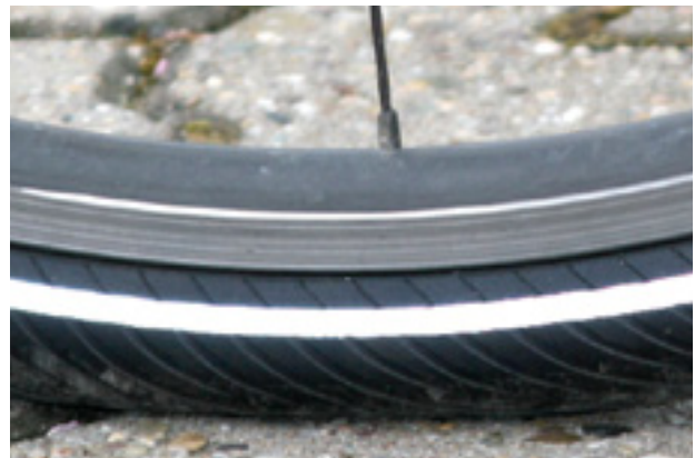
93. ábra: Helyes töltőnyomás. A gumiabroncs alakja a testsúly terhe alatt alig változik
