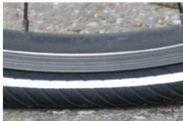
88. ábra: Túlontúl alacsony töltőnyomás
