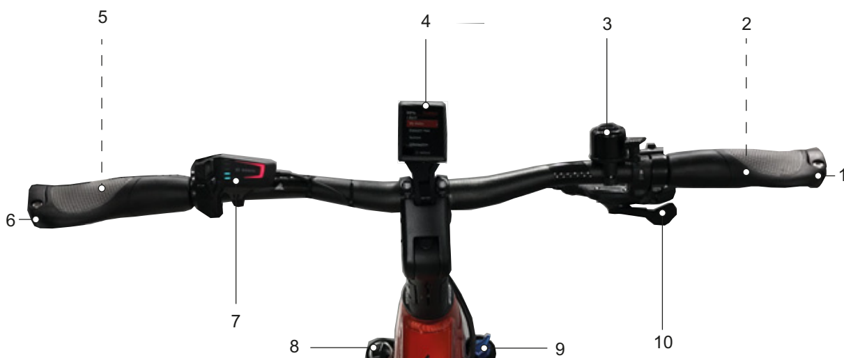
39. ábra: BOSCH Kiox300-zal felszerelt kormány részletes nézete, példa
