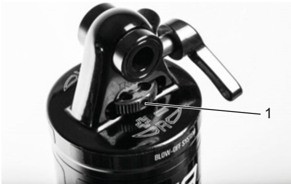
218. ábra: Suntour kerék húzófokozat-beállító (1) a hátsó lengéscsillapítón
