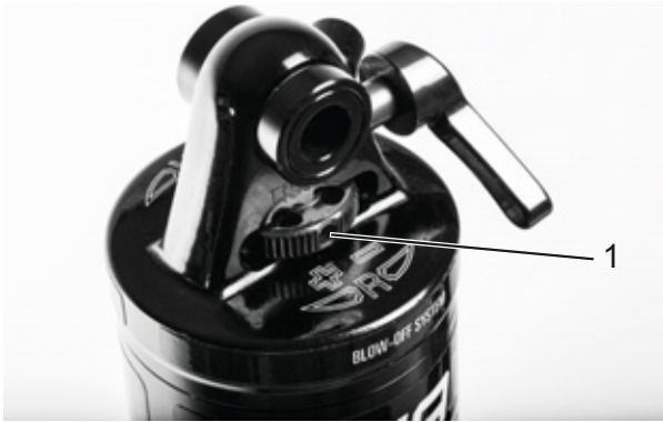
101. ábra: Suntour kerék húzófokozat-beállító (1) a hátsó lengéscsillapítón
