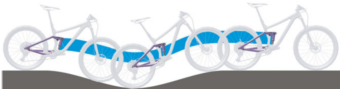
16. ábra: A hátsó lengéscsillapító optimális menetviselkedése dombos terepen
