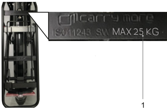
116. ábra: A csomagtartón fel van tüntetve maximális teherbírása (1)
