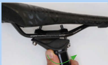
198. ábra: Magasságállítás nyitása
