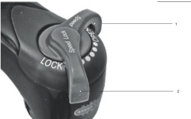
214. ábra: A nyomásfokozat-beállító keményebb beállítása
