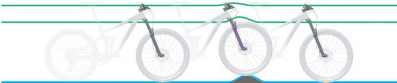
10. ábra: A villa optimális menetviselkedése egyenetlenségek esetén
