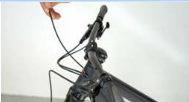
206. ábra: Végsapka beakasztása
