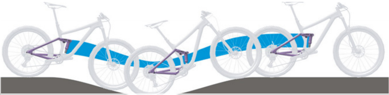
221. ábra: A hátsó lengéscsillapító túl puha rugózása hegymenetben
