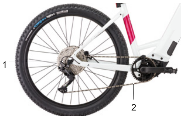
32. ábra: Külső váltóval felszerelt lánchajtás vázlata
