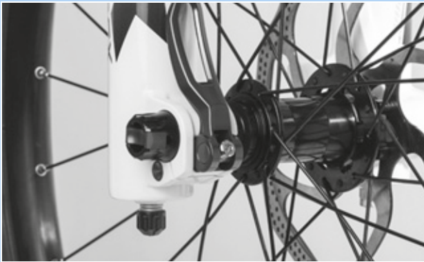
144. ábra: A gyorszár szorítóerejének beállítása
