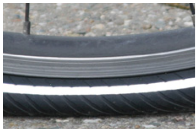
94. ábra: Túlontúl alacsony töltőnyomás
