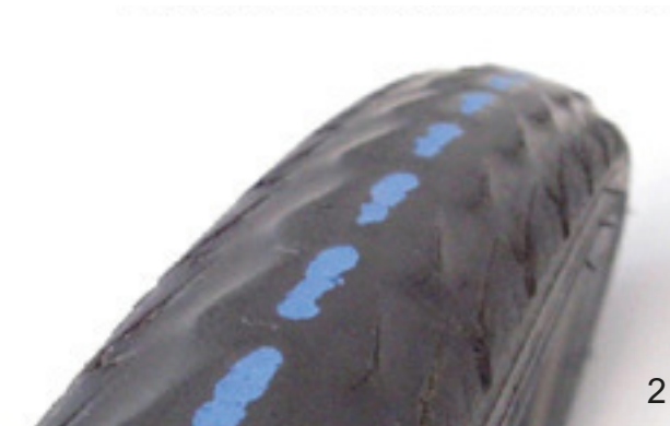
134. ábra: Profil nélküli gumiabroncs, amivel még kerékpározni lehet (1), és cserélendő gumiabroncs áttetsző defektvédelemmel (2)
