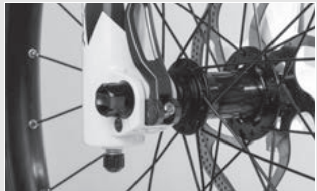
Abbildung 39: Spannkraft des Schnellspanners einstellen
