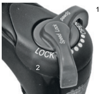
Abbildung 36: Suntour-Druckstufen-Einsteller mit den Positionen OPEN (1) und LOCK (2)
