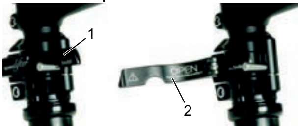
Abbildung 27: Geschlossener (1) und geöffneter (2) Vorbau-Spannhebel, Beispiel byschulz speed lifter
