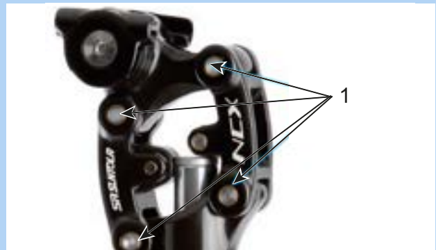
Figura 195: Punti di lubrificazione del canotto reggisella ammortizzato SR SUNTOUR
