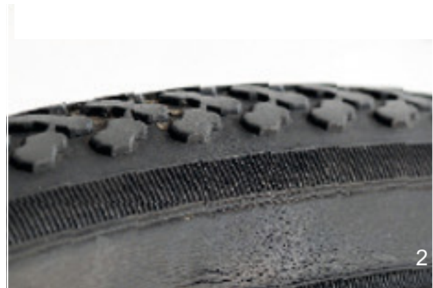
Figura 163: Esempi di crepe da fatica (1) e da invecchiamento (2)
