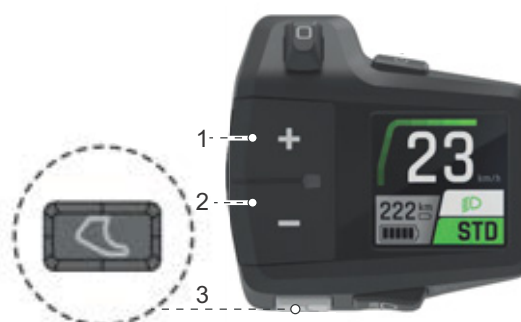
Figura 148: Ubicazione del tasto più (1), del tasto meno (2) e del tasto della funzione di assistenza di spinta (3)
