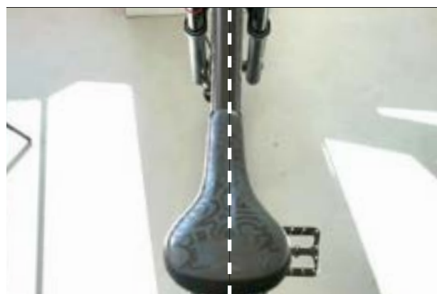
Figura 99: Posizionamento della sella in direzione di marcia
