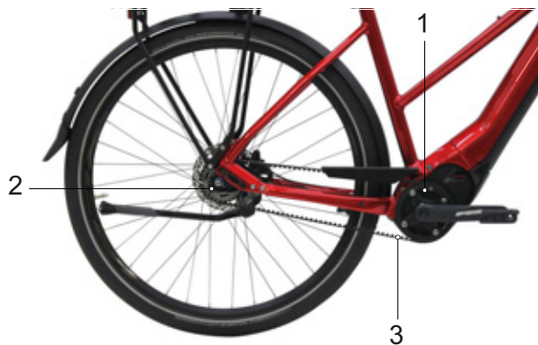
Figura 32: Schema della trasmissione a cinghia
