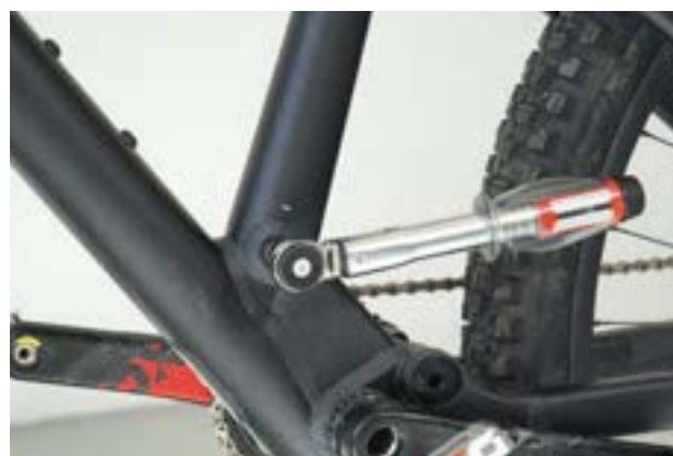
Figura 100: Serraggio dell'asse del canotto reggisella
