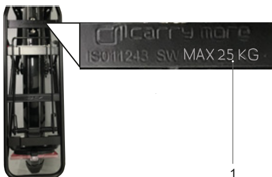
Figura 139: Sul portapacchi è indicata la sua portata massima (1)
