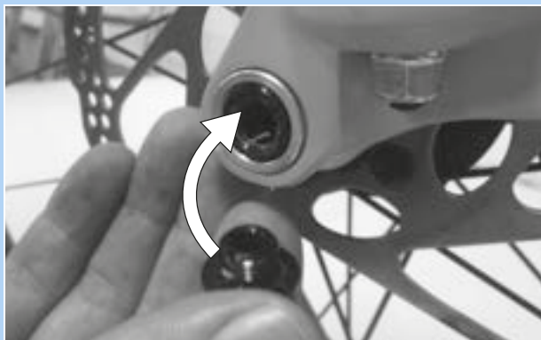
Figura 67: Applicazione della vite di sicurezza
