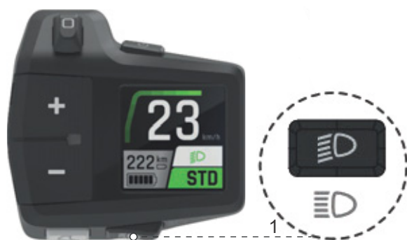
Figura 147: Ubicazione del tasto della luce di marcia
