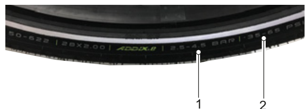
Figura 161: Pressione di gonfiaggio in bar (1) e in psi (2)
