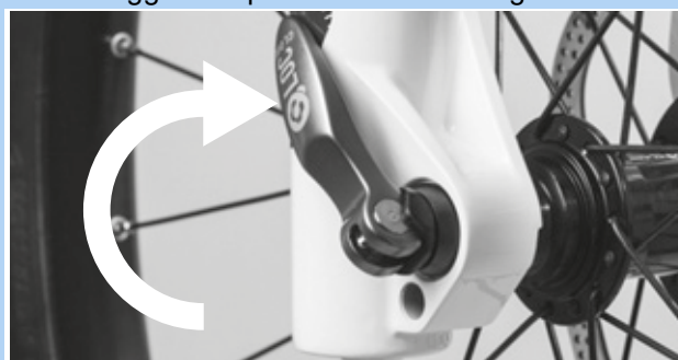
Figura 78: Chiusura del bloccaggio rapido
