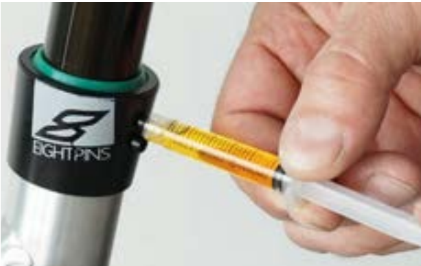
Figura 160: Lubrificazione del cannotto reggisella Eightpins
