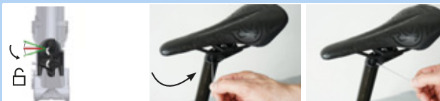
Afbeelding 193: Bediening hoogteverstelling in stand "geopend" zetten
