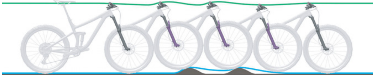
Afbeelding 265: Te langzaam uitveren van de verende voorvork
