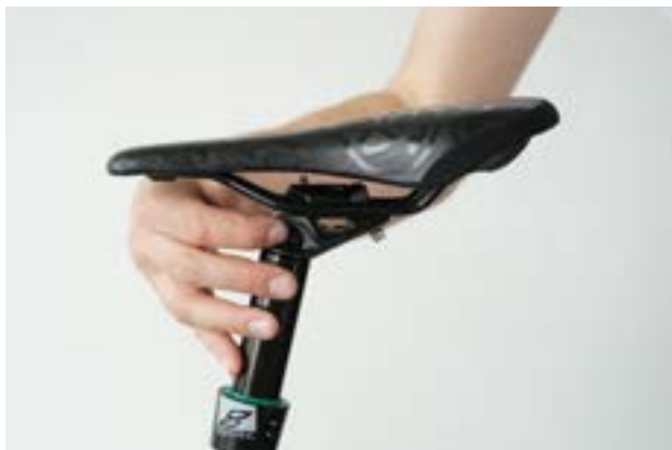
Afbeelding 102: Zadelhoek afstellen met het instelwiel
