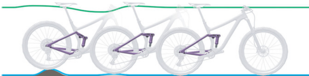
Afbeelding 279: Te snel uitveren van de achterbouwdeemper
