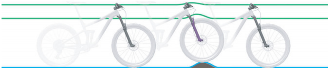
Afbeelding 11: Optimaal rijgedrag van de vork bij oneffenheden
