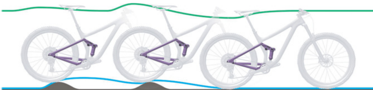
Afbeelding 281: Te langzaam uitveren van de achterbouwdemper
