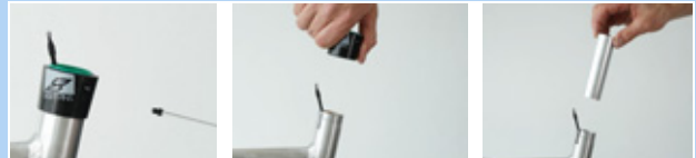
Afbeelding 235: Buitenhuls en glijbus demonteren
