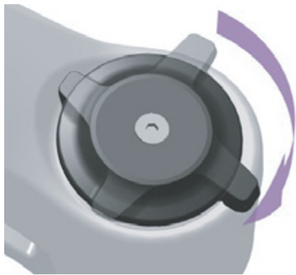
Afbeelding 268: Drukdemperafsteller harder afstellen
