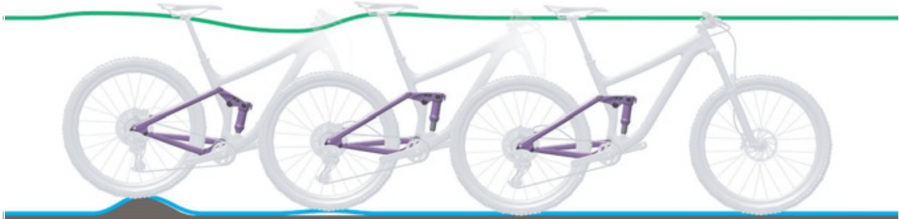
Afbeelding 271: Te snel uitveren van de achterbouwdemper
