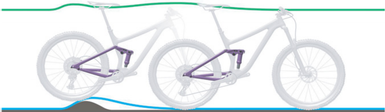
Afbeelding 285: Te harde demping van de achterbouwdemper bij oneffenheden
