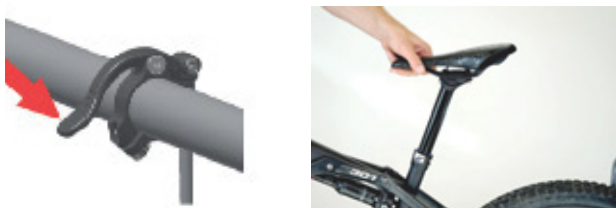
Afbeelding 94: Hydraulische gasveer uitschuiven
