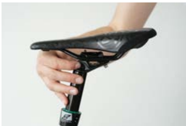
Afbeelding 106: Zadelhoek afstellen met het instelwiel
