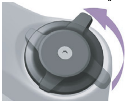
Afbeelding 172: Drukdemperafsteller zachter afstellen
